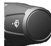
Taste für Frontscheibenwaschanlage
