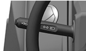
Hebel für Beleuchtung
