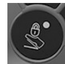
RXA0168434—UN—30MAY19 Taste zum Sperren des Gaspedals
