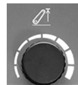
Drehknopf für Hubbegrenzung des Krafthebers
