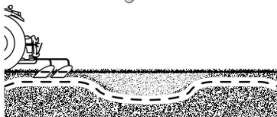
Bei variierenden Bodenverhältnissen führt ein hoher Wert zu größeren Tiefenvariationen.
