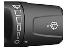
Geschwindigkeit für Frontscheibenwischer
