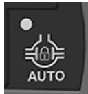
RXA0168428—UN—30MAY19 Automatiktaste für Differenzialsperre
