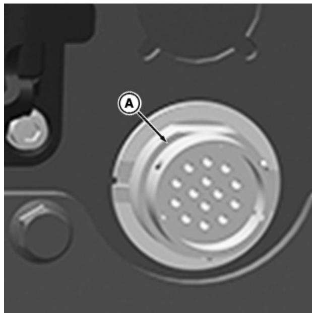
RXA0179346—UN—24AUG20 AutoLoad-ledningstilslutning befinder sig over SCV-gruppen
