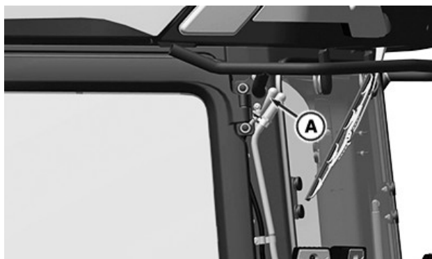
RXA0180432—UN—12NOV20 Brændstoftankens udluftningsfilter (A) — Hjørnestolpe bagerst til venstre i førerkabinen
