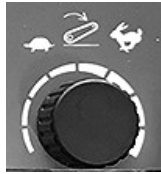
Drehknopf für Senkgeschwindigkeit des Krafthebers
