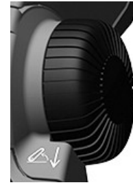
RXA0168025—UN—17MAY19 Drehknopf für Tiefeneinstellung des Krafthebers
