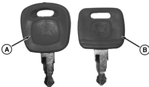
RXA0108294—UN—24JUN10 Chave com Imobilizador Comparada à Chave John Deere Padrão
