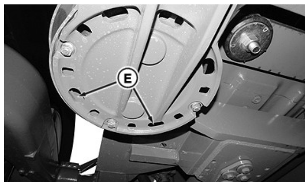
Burduful de aer al balansierului din spate
