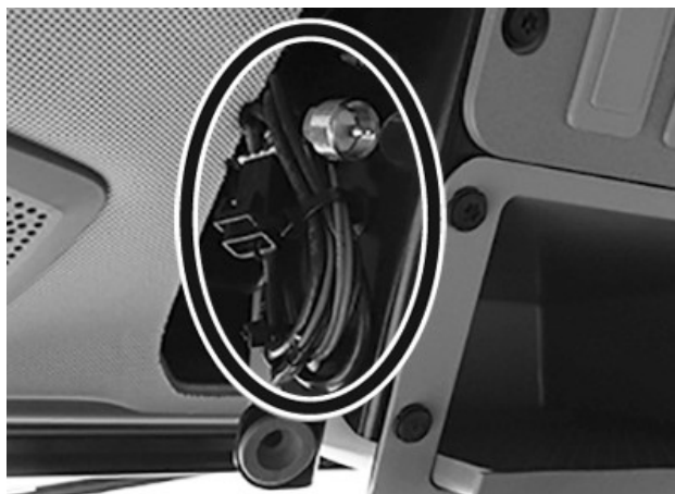
Antena și cablurile de alimentare
