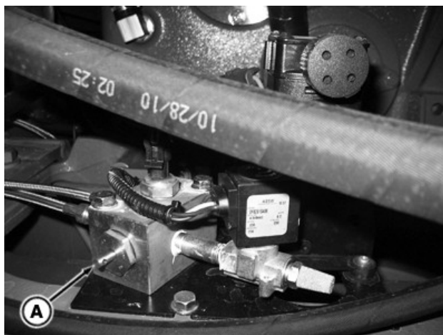
RXA0114907—UN—09MAY11 Supapa de ventilație-Deasupra punții de suspensie
