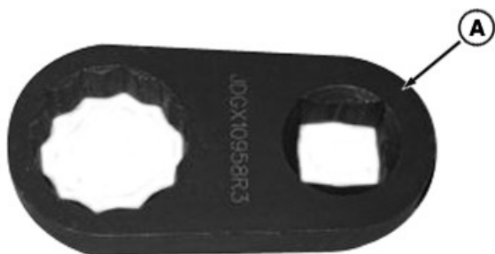
RXA0100328—UN—03FEB09 JDG10958 Hållarnyckel för hjulvikter
