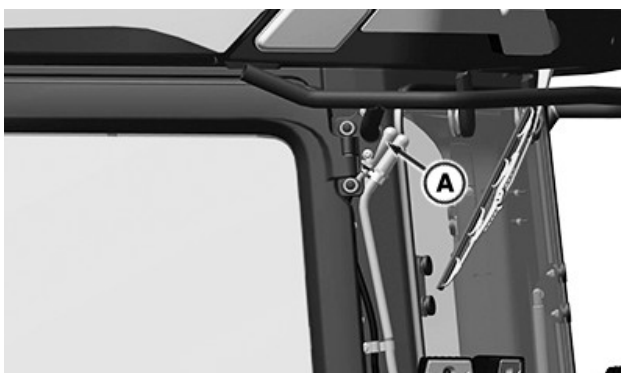
Bränsletankens ventilationsfilter (A)—Vänster hörnstolpe baktill på hytten
