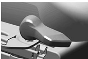
Reglage för vridningsspärr
