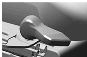
Reglage för vridningsspärr RXA0167322—UN—03APR19
