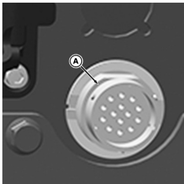
Uttag för anslutning av AutoLoad-kabelhärvan ovanför hydrauluttagsblocket
