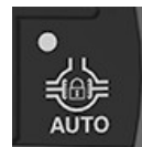
Knapp för AUTOMATISK differentialspär
