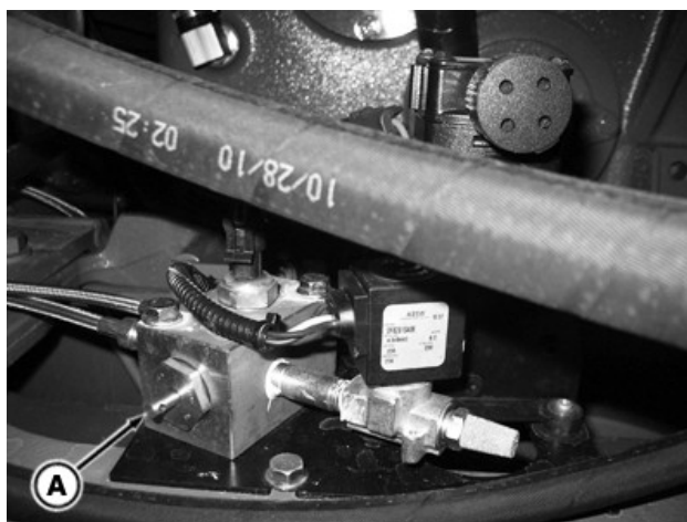
Avluftningsventil – över fjädrande axel
