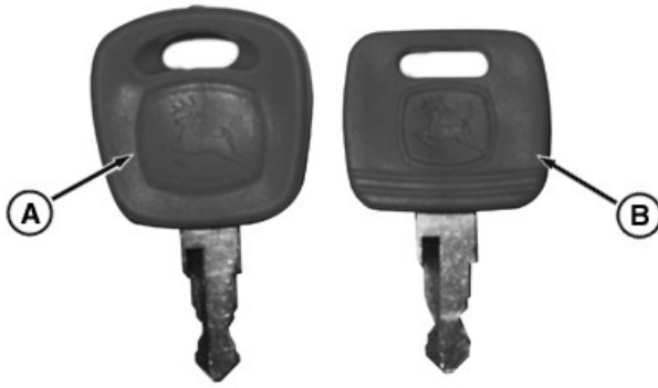
RXA0108294—UN—24JUN10 Kľúč imobilizéra v porovnaní so štandardným John Deere kľúčom
