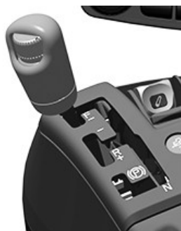
Приклад блока керування частотою обертання та зміщенням
