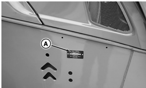
Табличка з ідентифікаційним номером виробу (A) розташована на правому боці рами трактора
