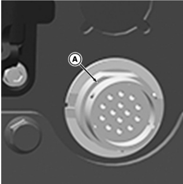
RXA0179346—UN—24AUG20 Гніздо роз'єму проводки AutoLoad знаходиться над групою клапанів SCV
