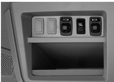
Приклад блоків керування електричним дзеркалом
