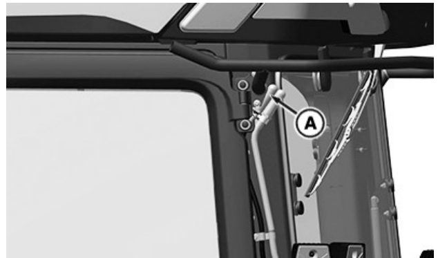
Вентиляційний фільтр паливного бака (А) — ліва кутова стійка кабіни RXA0180432—UN—12NOV20
