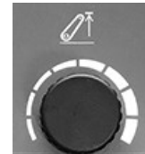
RXA0168029—UN—17MAY19 Selector de límite superior del enganche
