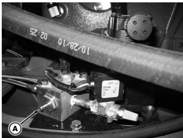
RXA0114907—UN—09MAY11 Воздушный клапан над системой подвески
