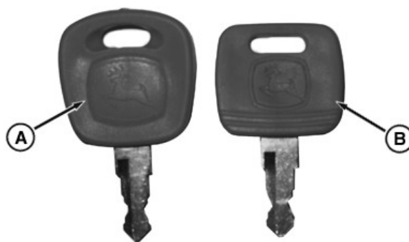
RXA0108294—UN—24JUN10 Llave del dispositivo antiarranque frente a llave estándar de John Deere
