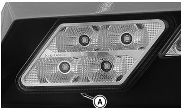
RXA0172759—UN—03DEC19 Strålkastare på taket—Lampa för LED-belysning visas
