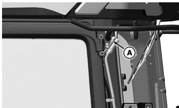
RXA0180432—UN—12NOV20 Odvzdušňovací filter palivovej nádrže (A)-ľavý zadný rohový stĺpik kabíny
