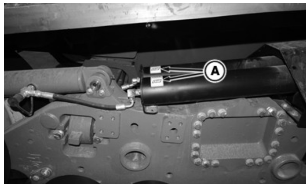
A—Označenie akumulátora (na ľavej aj pravej strane traktora)
