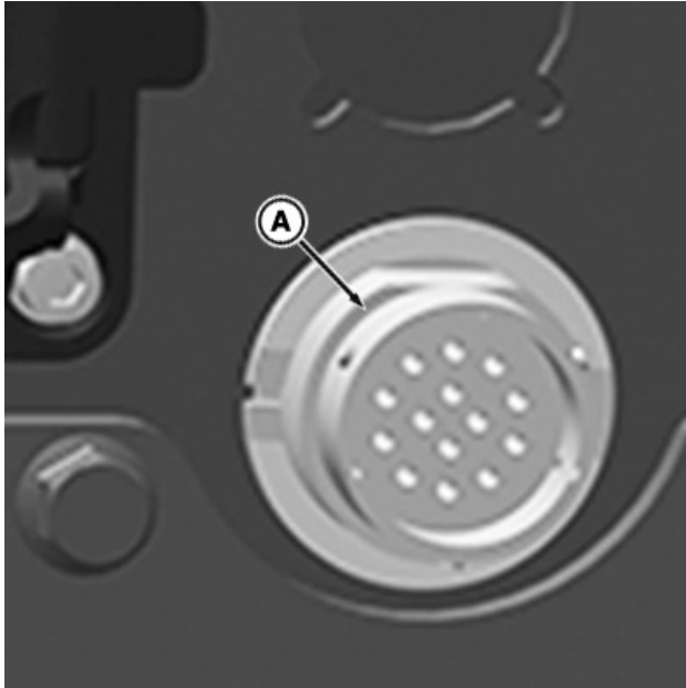
RXA0179346—UN—24AUG20 Гніздо роз'єма джгута проводки AutoLoad™ знаходиться над групою клапанів SCV
