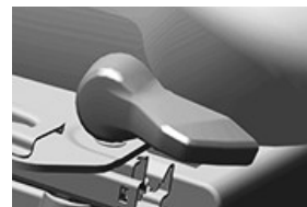
Блок керування блокуванням від повороту
