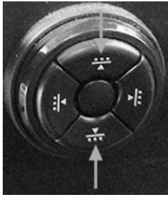
Блок керування висотою поперекової опори (Ultimate)
