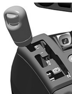
Приклад блока керування частотою обертання та зміщенням
