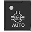
Кнопка автоматичного режиму механізму блокування диференціала
