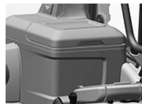
RXA0167977—UN—17MAY19 Приклад холодильника й охолоджувального блока / ящика для зберігання
