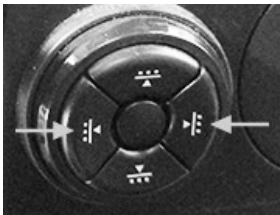
Блок керування подовжувача поперекової опори (Ultimate)
