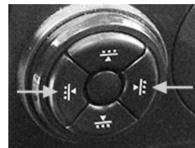
Блок керування подовжувача поперекової опори (Ultimate)
