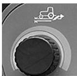
Drejegreb til træktøjets belastningsdybde
