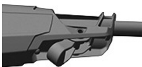
RXA0167461—UN—12APR19 Лост за заключване на ръчното управление на телескопичните опори
