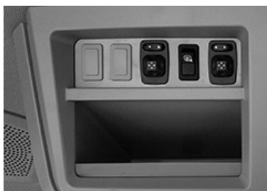
RXA0168462—UN—31MAY19 Пример за уреди за управление на електрическите огледала
