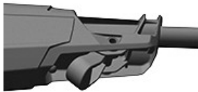
Palanca de bloqueo de la función telescópica manual
