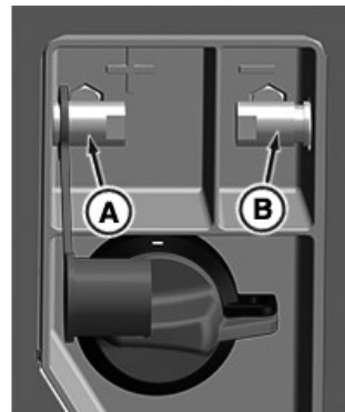
Аккумуляторнинг алмашиш клеммаси трактор зиналари яқинида жойлашган.
