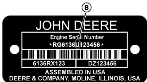
Przykład tabliczki z numerem seryjnym silnika
