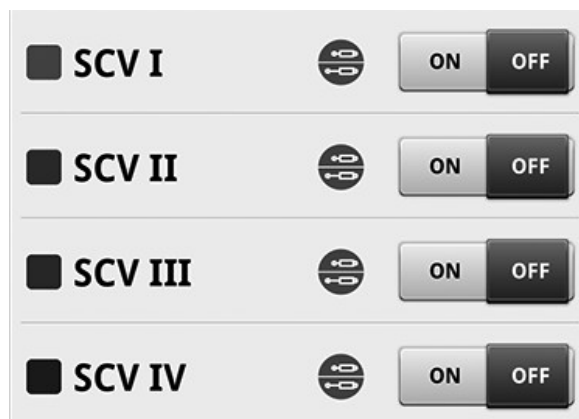
Príklad nezávislého režimu ventilov vonkajšieho okruhu
