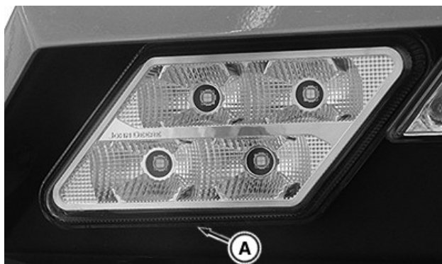
Strešné osvetlenie kabíny – zobrazená možnosť LED svetla RXA0172759—UN—03DEC19
