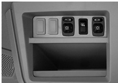
Príklad ovládacích prvkov elektrického zrkadla
