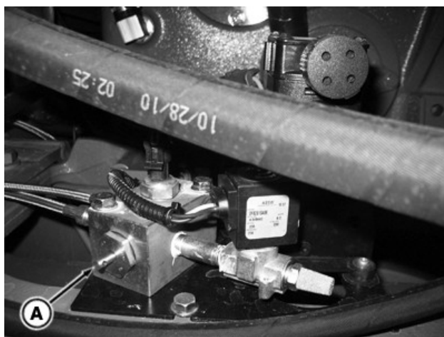
Ventil za odzračivanje iznad osovine ovjesa
