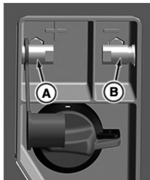
RXA0187645—UN—10AUG22 Akumulatoriaus jungiamųjų laidų gnybtai yra šalia traktoriaus laiptelių.
