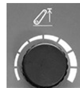
RXA0168029—UN—17MAY19 Prikabinimo įtaiso viršutinės ribos reguliavimo rankenėlė
