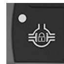
Butonul pentru mecanismul de blocare a diferențialului
