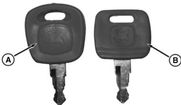
RXA0108294—UN—24JUN10 Ključ blokade u usporedbi sa standardnim John Deere ključem
