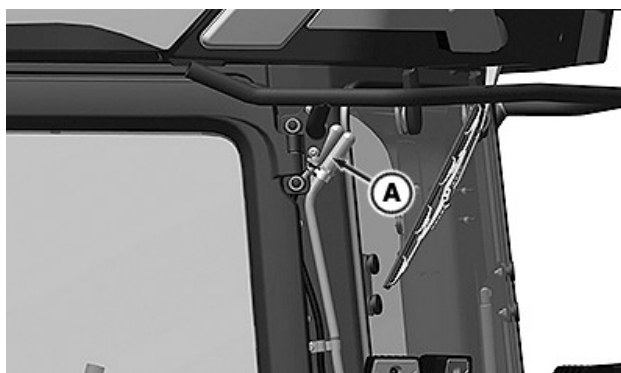
Вентилационният филтър на резервоара DEF (A) е близо до горната част на задния ляв ъгъл на кабината.
