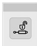
Distributeurs auxiliaires déverrouillés
