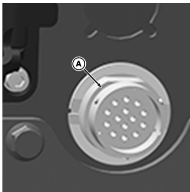
RXA0179346—UN—24AUG20 La prise du connecteur de faisceau AutoLoad se situe au-dessus du bloc de distributeurs auxiliaires
