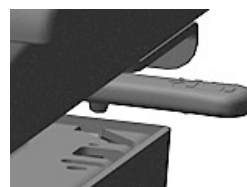
RXA0167345—UN—03APR19 Ovládání zablokování proti posuvu doleva/doprava
