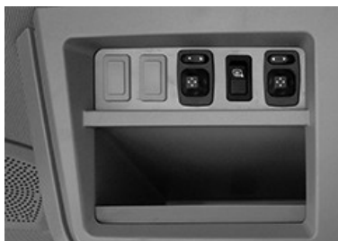
RXA0168462—UN—31MAY19 Příklad ovládacích prvků elektrického zpětného zrcátka
