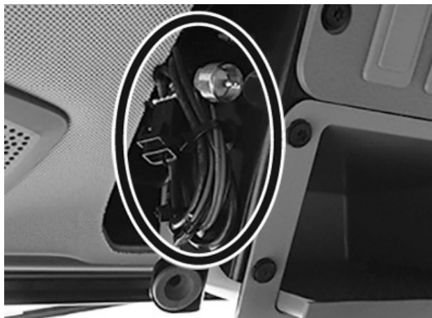
Anténa a napájecí kabely
