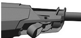
RXA0167461—UN—12APR19 Zajišťovací páka ručního vysouvání
