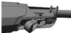
RXA0167461—UN—12APR19 Ručica za blokiranje ručnog teleskopskog mehanizma
