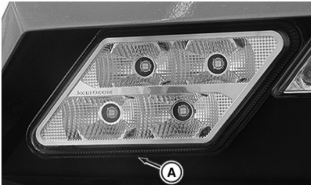
Phare sur pavillon—Option d'éclairage à LED illustrée
