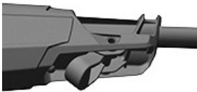
RXA0167461—UN—12APR19 Palanca de bloqueo de la función telescópica manual
