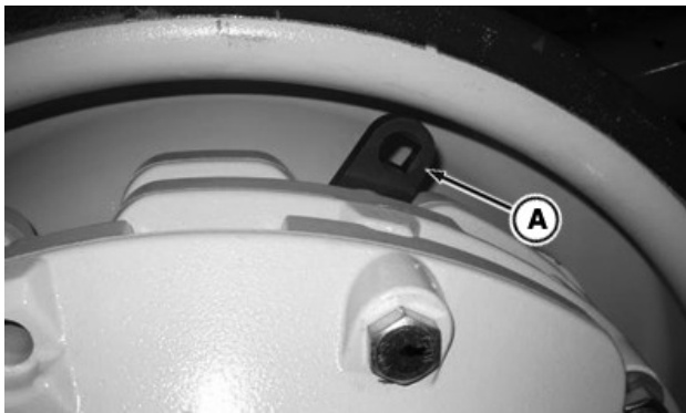
RXA0100328—UN—03FEB09 Llave de sujeción de contrapesos de rueda JDG10958
