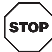
RG22493—UN—21AUG13 Indicador de parada del motor
