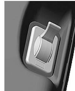
Palanca del freno de emergencia RXA0169485—UN—02JUL19
