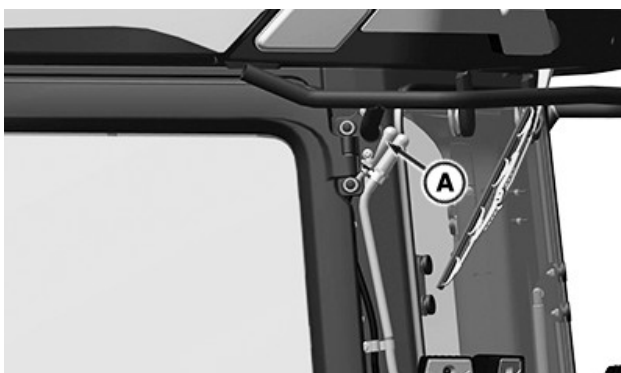
RXA0180432—UN—12NOV20 Filtre de l'orifice de dégazage du réservoir de carburant (A) —Montant d'angle arrière gauche de la cabine
