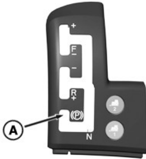
RXA0140499—UN—16APR14 Levier d'inverseur sur console en position de STATIONNEMENT
