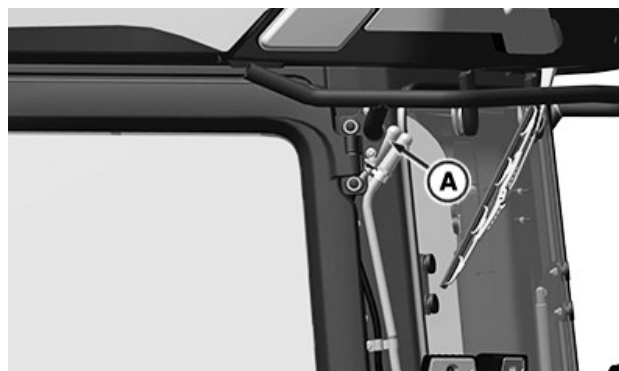
Фильтр вентиляции топливного бака (А) — левая задняя угловая стойка кабины
