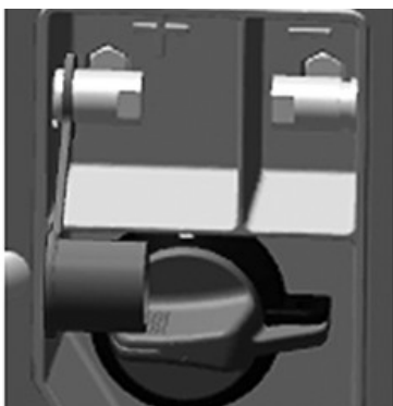
РХА0185275—UN—01SEP21 Выводы перемычки аккумуляторной батареи расположены рядом с лестницей трактора.
