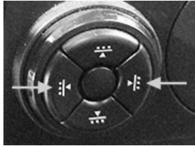
Commande d'extension lombaire - Ultimate
