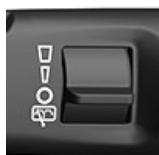
Levier de vitesse d'essuie-glace/lave-glace droit/arrière
