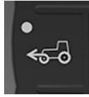
Touche Pont avant
