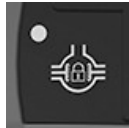
Bouton de blocage du différentiel
