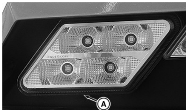
Phare sur pavillon—Option d'éclairage à LED illustrée
