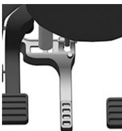
RXA0167454—UN—12APR19 Pédale d'inclinaison avec mémoire
