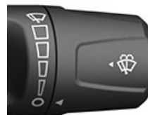
RXA0167456—UN—12APR19 Vitesse de l'essuie-glace avant
