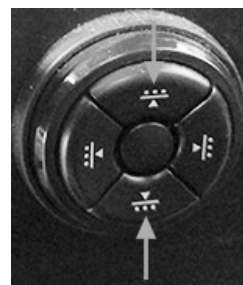
RXA0167331—UN—03APR19 Commande de hauteur lombaire - Ultimate
