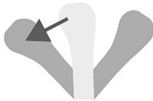
RXA0167696—UN—30APR19 Désenclencher la prise de force
