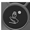
Bouton de verrouillage de la pédale d'accélération
