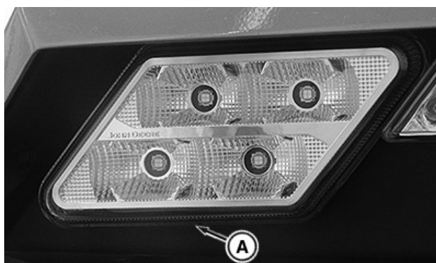
Phare sur pavillon—Option d'éclairage à LED illustrée
