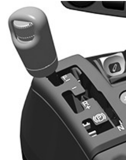
Levier d'inverseur sur console
