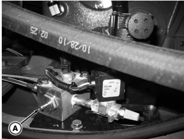
Soupape d'évacuation au-dessus de l'essieu de suspension
