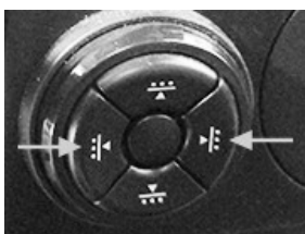
Commande d'extension lombaire - Ultimate
