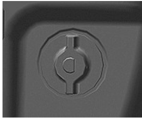
RXA0167320—UN—03APR19 Commande de hauteur d'accoudoir
