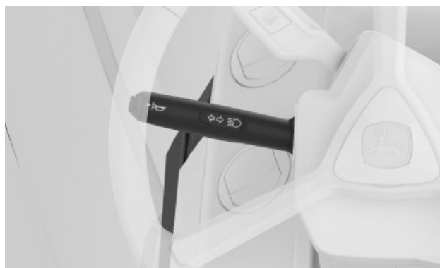
Levier d'éclairage (boîte 16 vitesses uniquement)
