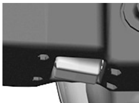
RXA0167321—UN—03APR19 Commande de l'inclinaison de l'accoudoir
