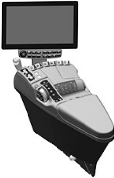
RXA0188010—UN—13SEP22 Exemple de CommandARM
