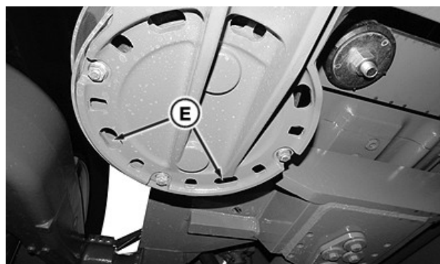
Coussin d'air de balancier arrière
