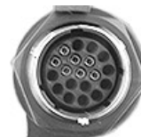
RXA0167988—UN—17MAY19 Connecteur de la console GREENSTAR
