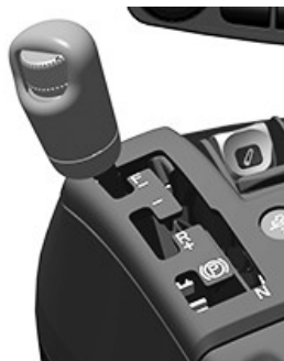
RXA0171324—UN—10OCT19 Exemple de commande de vitesse/de sélection
