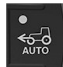
RXA0168426—UN—30MAY19 Bouton AUTOMATIQUE du pont avant mécanique
