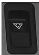
Contacteur des feux d'avertissement pour le remorquage
