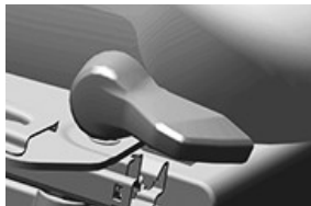
RXA0167322—UN—03APR19 Commande de verrouillage du pivotement
