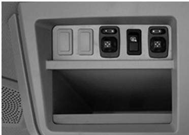
Exemple de commandes des rétroviseurs électriques
