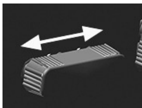
RXA0167328—UN—03APR19 Commande de position d'avancement/de recul - Premium et Ultimate
