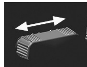
RXA0167328—UN—03APR19 Commande de position d'avancement/de recul
