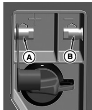
RXA0187645—UN—10AUG22 Batteriets koblingskabelklemmer er placeret i nærheden af traktorens trin.
