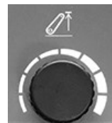
RXA0168029—UN—17MAY19 Prikabinimo įtaiso viršutinės ribos reguliavimo rankenėlė
