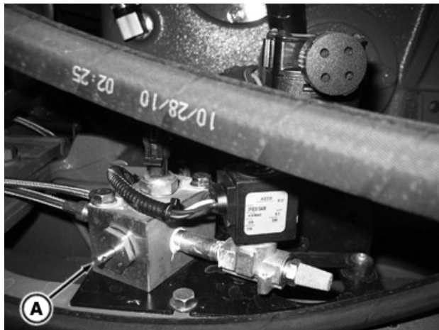
RXA0114907—UN—09MAY11 Válvula de ventilação acima do eixo suspenso
