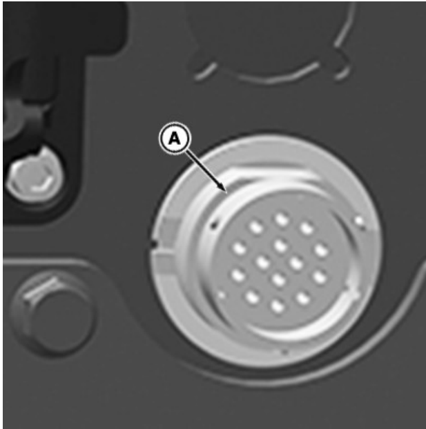
RXA0179346—UN—24AUG20 Saída do Conector do Chicote Elétrico AutoLoad Acima do Conjunto da VCR
