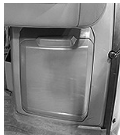
RXA0167996—UN—17MAY19 Armazenamento do Para-Lama 9RT
