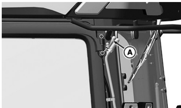
Отын багының желдету сүзгісі (A) — сол жақ артқы кабинаның бұрыштық бағаны
