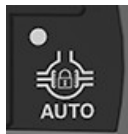
Pulsante bloccaggio automatico del differenziale (AUTO)
