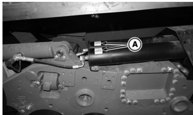
A—Etichetta accumulatore (lato sinistro e lato destro su ciascun lato del trattore)
