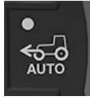
Pulsante trazione anteriore automatica (AUTO)
