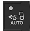
Bouton AUTOMATIQUE du pont avant mécanique
