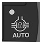
Bouton de blocage automatique du différentiel
