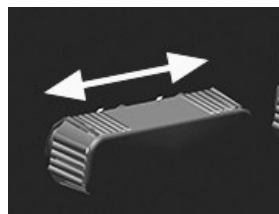
RXA0167328—UN—03APR19 Commande de position d'avancement/de recul
