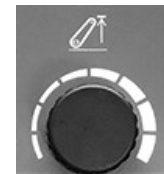
Molette de réglage de la limite supérieure du relevage
