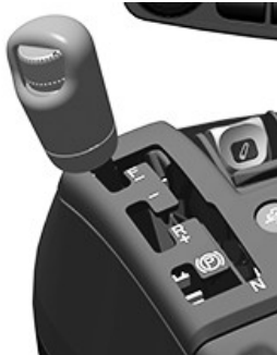
Exemple de commande de vitesse/de sélection
