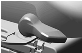
RXA0167322—UN—03APR19 Commande de verrouillage du pivotement
