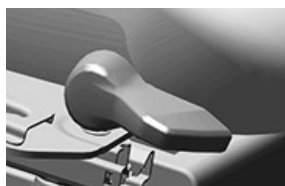
Commande de verrouillage du pivotement
