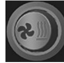
RXA0173802—UN—14JAN20 Control de ventilación/calefacción — Ultimate
