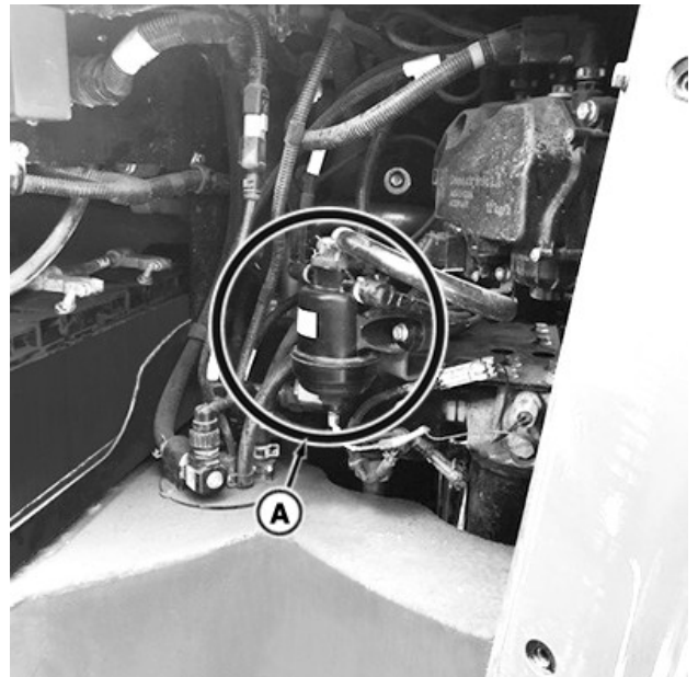
El filtro en línea de fluido de escape diésel (DEF) (A) está dentro del compartimento de la batería.
