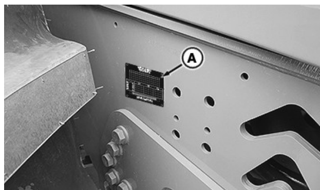
Pločica s PIN-om (A) na desnoj je strani okvira traktora
