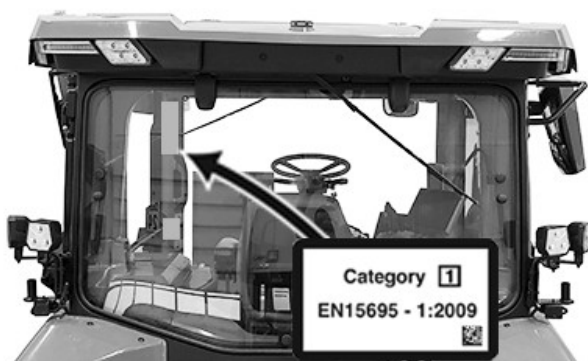
RXA0186207—UN—01DEC21 Naljepnica je tu samo radi boljeg prikaza na crtežu (ne pokazuje kategoriju ugrađene kabine)
