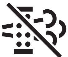
RG22490—UN—21AUG13 Indicador de limpieza automática desactivada
