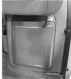
RXA0167996—UN—17MAY19 Almacenamiento del guardabarros de 9RT
