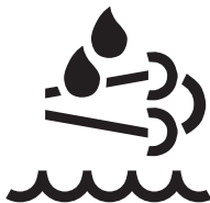
RG22487—UN—21AUG13 Indicador de fluido de escape diésel
