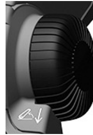
RXA0168025—UN—17MAY19 Cudrante de ajuste de profundidad del elevador hidráulico
