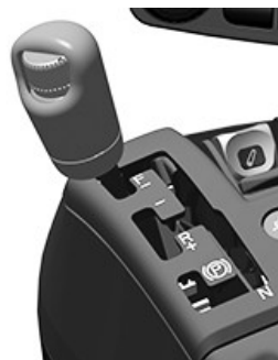
Inversor con mando en lado derecho
