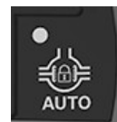
Botón de bloqueo del diferencial automático
