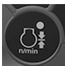
Botón de modo manual del motor
