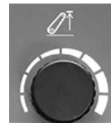
RXA0168029—UN—17MAY19 Selector de límite superior del enganche
