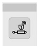
RXA0180094—UN—09OCT20 Ventily SCV odblokované
