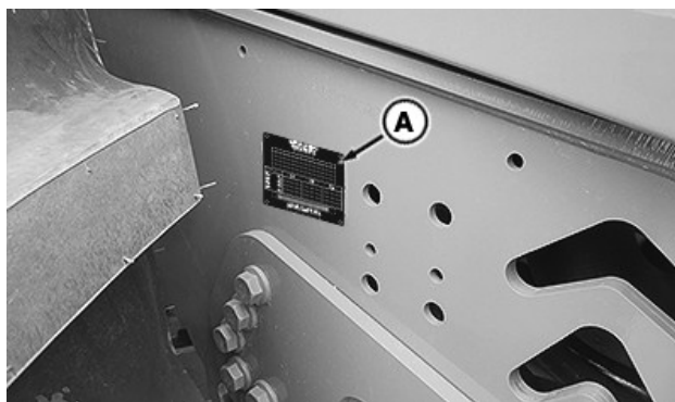
Štítek čepu (A) je na pravé straně rámu traktoru
