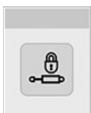
RXA0180093—UN—09OCT20 Ventily SCV zablokované
