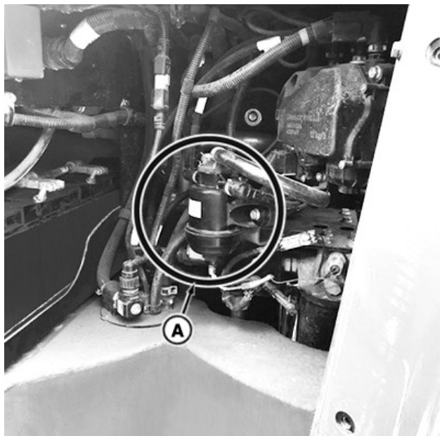
Filtr płynu DEF (A) znajduje się wewnątrz skrzynki akumulatora.
