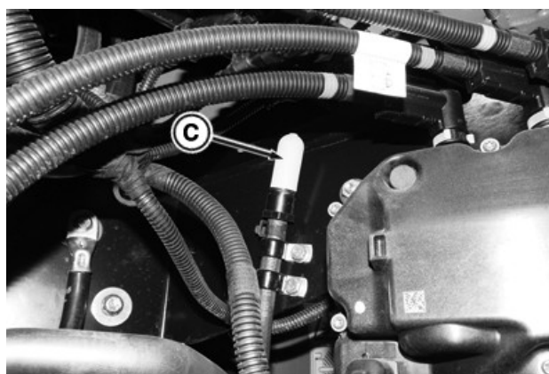
Vandens karbamido tirpalo bako alsuoklio filtras (C) yra akumulatoriaus skyriuje, virš vandens karbamido tirpalo dozatoriaus.
