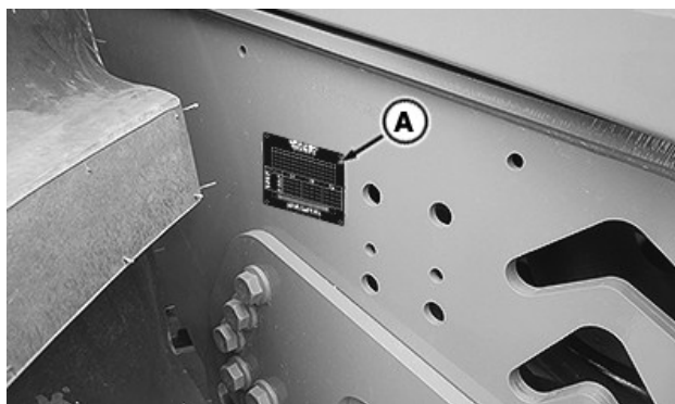
PIN-plattan (A) sitter på traktorramens högra sida
