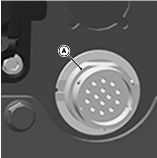
RXA0179346—UN—24AUG20 Ieșirea conectorului AutoLoad™ al cablajului se află deasupra stivei SCV
