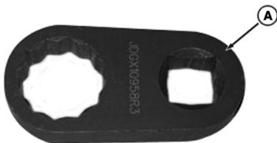
JDG10958 — klucz podtrzymujący do obciążników kół
